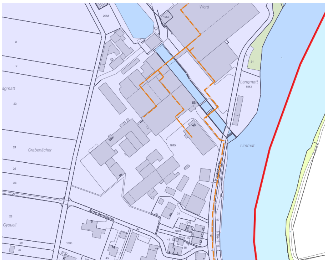
Abbildung 36: Bestehende Fernwärmeerschliessung (orange) (Quelle: geoProSuisse)
