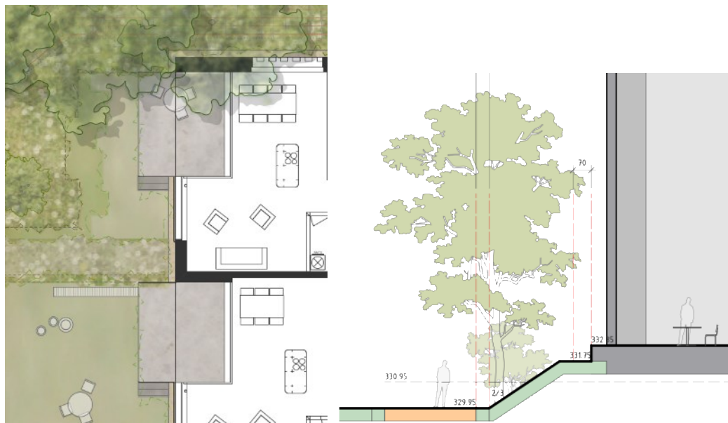
Abbildung 42: Erhöhte, über die Fassadenlinie vorspringende Terrassensockel (links: Auszug aus dem Richtprojekt, rechts: Schemaschnitt der Duplex Architekten AG)
